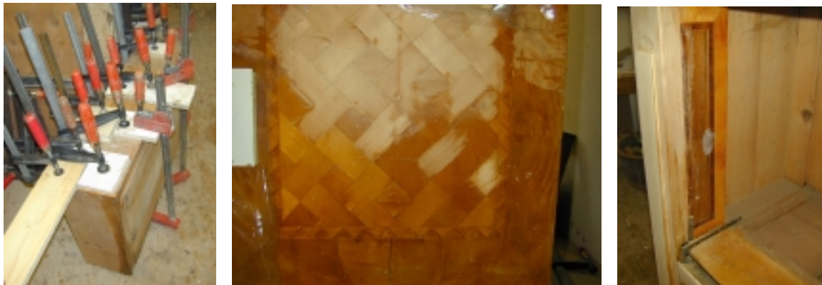
Detail: Beschlag vorher, Beschlag ausgeleimt, Beschlag nachher
