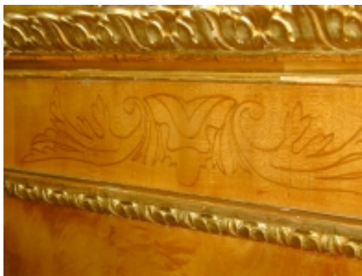
Detail: Rißschäden, aufgezugene Furnierflächen, fehlende Furnierteile und Ausbrüche
