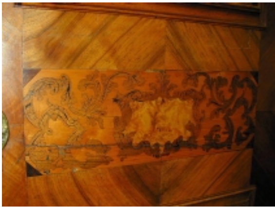
Detail: Fehlstellen bei Furniere, Rißstellen an Oberfläche, abgehobene Furnierflächen von Untergrund
