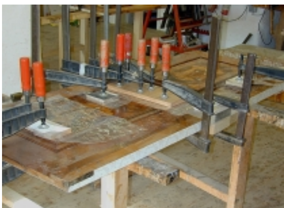
Detail: Verleimungsarbeiten bei den Türen und Deckelkranz
